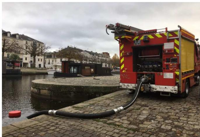
**Mise en aspiration directe d'un FPT à l'aide de tuyaux d'aspiration**
