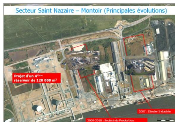
Projet d'un 4<sup>ème</sup> réservoir de 190 000 m<sup>3</sup> au terminal méthanier (les trois premiers réservoirs font 120 000 m<sup>3</sup> chacun)
